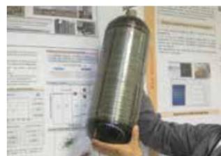
↑ Bouteille composite dédiée à contenir de l'hydrogène sous haute pression, un exemple de développement de structure intelligente.
