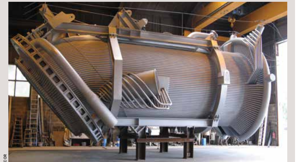
↑ SCCM est spécialisée dans les équipements thermiques et mécaniques intervenant dans des process à haute température. Ici, une hotte convertisseur let.
