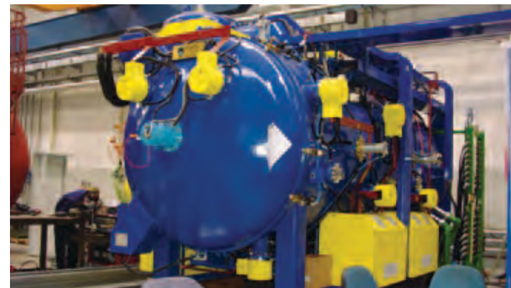
Le four de brasage sous vide et sans atmosphère contrôlée du pôle brasage à l'EEIGM.
