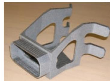
Ferrure TA6V réalisée par fusion de lits de poudre/ usinage dans la masse
