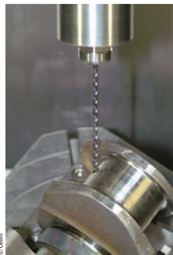
FGVV : forer en profondeur sans lubrifiant.
