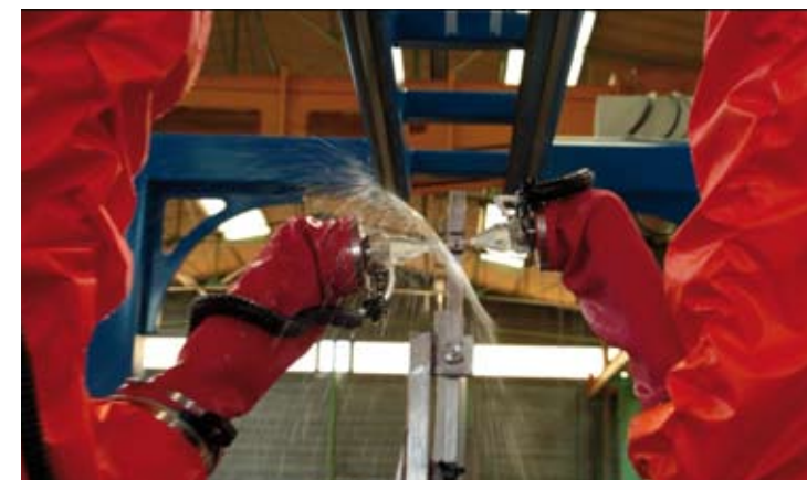
Le C-Scan jet d'eau est équipé de deux robots polyarticulés synchrones et d'un plateau tournant.
