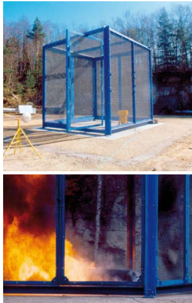
Cages grillagées pour essais d'incendies
