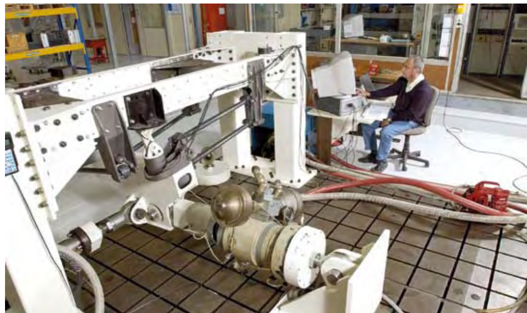
Banc de fatigue du Cetim utilisé notamment par l'industrie aéronautique
