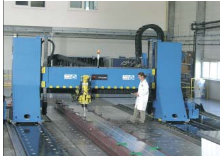
SOUDAGE PAR FRICTION STIR WELDING de profilés en aluminium dans le centre dédié à ce procédé de l'Institut de Soudure.
