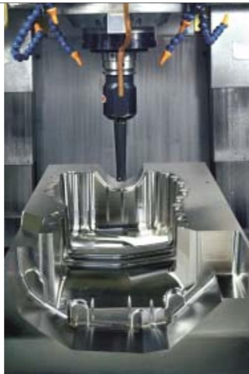
USINAGE d'un moule pour une machine-outil.
