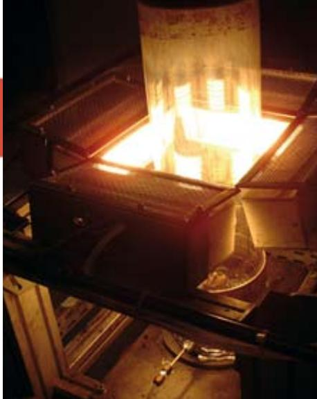
**Essai de la réaction au feu de la molécule 2,5 Di méthylfurane**, voie de recherche dans la formulation de nouveaux carburants pour l'aéronautique.
